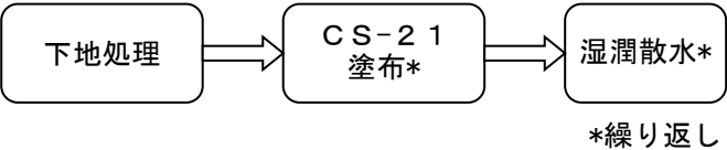
工法概要図（CS-21塗布ひび割れ補修工法）
