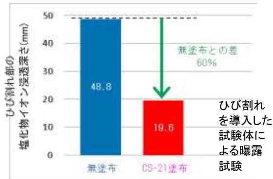
【①】CS-21塗布のひび割れ部の塩化物イオンの浸透深さは、無塗布の40%（抑制率60%）であった。
