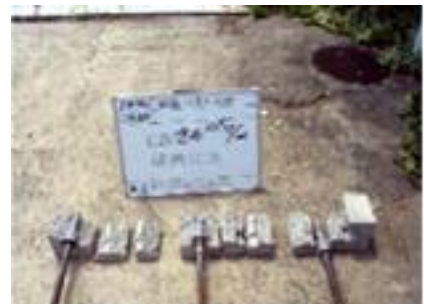
写真9 破壊状況(CS-21 塗布)
