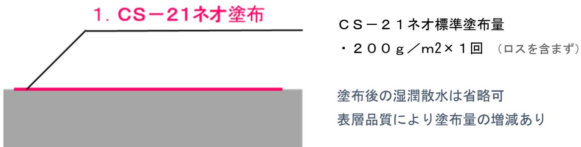
図2 CS-21ネオ塗布工法 工程概要図
