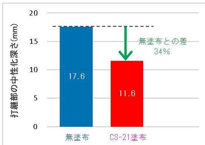
図11 打継部の中性化深さ測定結果グラフ
