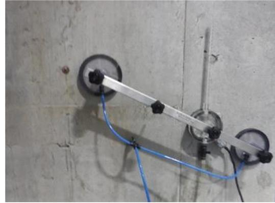
写真 16 表面吸水速度測定状況
