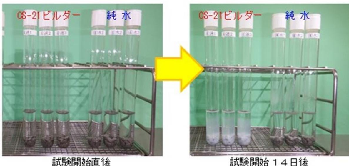
写真4 種類判定試験（ろ液の反応性確認）
