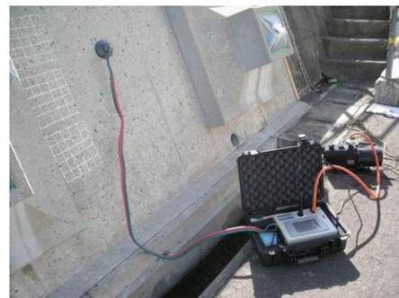
写真16 透気試験機：パーマ・ツール測定状況
