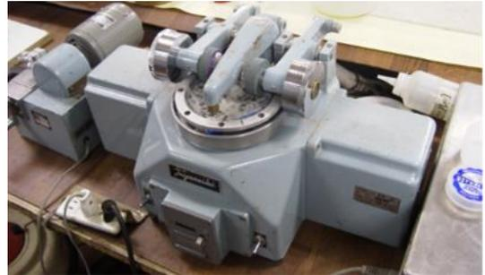
写真13 摩耗試験装置の例
