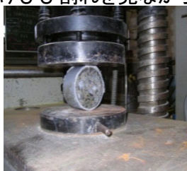
図3.8.6 ひび割れ作製状況
