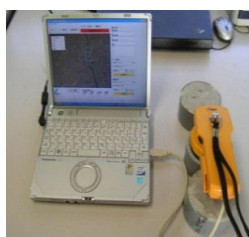
図3.8.7 ひび割れ幅測定状況 注(3)
