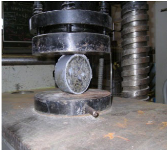
図3.1.2 ひび割れ作製状況
