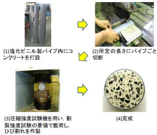
図1 微細ひび割れ試験体の作製方法
