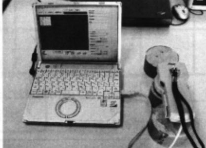
ひび割れ幅測定状況
