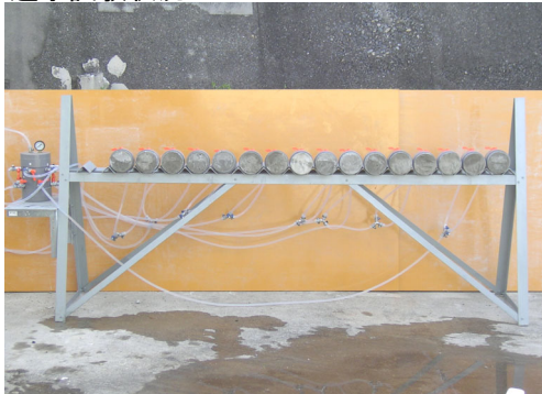
透水試験状況
