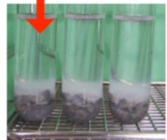
比較用の純水では変化が見られないが、CS-21ビルダーでは試験開始から28日後時点で白濁が確認できた
